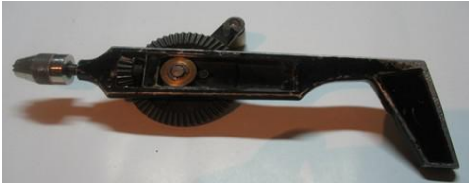
Ruční vrtačka: nástroj určený k vytvoření děr.
