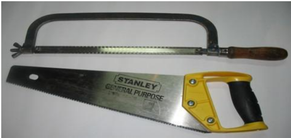
Ruční pila: je nástroj k oddělování/řezání materiálu. Pily se dělí na pily na dřevo, kov, kámen aj.
